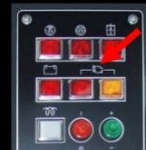
エンジンに不具合が発生するとエンジン警告ランプ（赤）が点灯します。エンジン診断ランプ（橙）は発生した不具合の内容を点滅回数で表示します。
