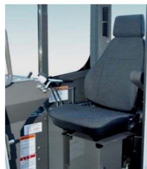
ソフトな乗り心地のハイバックシートを標準装備。シートの前後調整、リクライニング調整で最適な作業姿勢が得られるようにシートの位置を調整してください。ROPS/FOPSキャビン装着車は、シートベルトが標準装備となります。
