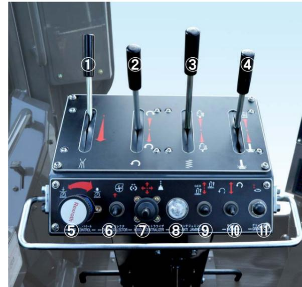
せん孔系操作レバーと操作スイッチを配置したコントロールスタンドをチルト式に変更。角度調整により、最適なポジションでスピーディなせん孔操作が行えます。
