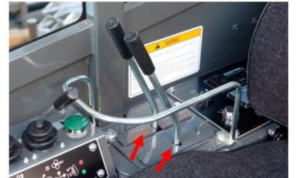
走行レバー部には、セフティロックを付けています。走行時以外のときは、万一の誤操作を防止するため走行レバーをロックしてください。（写真はロック位置）
