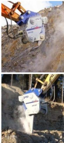
偏心ギヤを油圧モータで回し、発生する振動をアキュムレータで増幅、先端のツールに力を集中させることで掘削・解体を行うことができる革新的な振動増幅式リッパです。油圧ブレードと油圧ショベルの中間的な破碎機で、バケット作業にはない破碎力、油圧ブレードではできないかき寄せ作業等ができる大きな利点があります。石灰石鉱山や採石場などのベンチ掘削・端縁処理などに有効に活用でき、高い生産性を発揮します。硬い岩盤ではドリルやブレードと併用することでリッパの作業範囲が広がり、生産効率がアップします。
