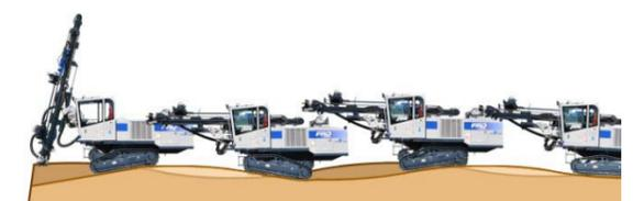
オシレーティング機能により、左右の履帯がそれぞれ接地するため安定した走行となる。
