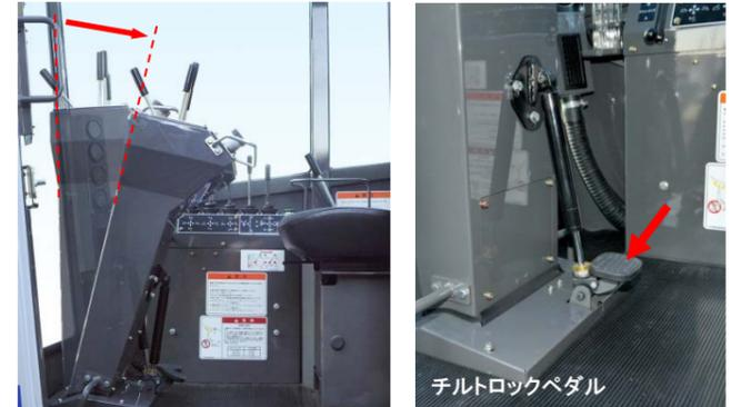
最適なせん孔操作ポジションが得られるチルト式コントロールボックスを採用。チルトロックペダルを踏んで角度を調整します。せん孔系圧力計類は、センターピラー部に移動し、視認性を良くしました。
